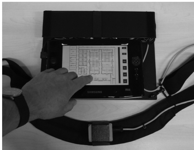
Abbildung 1: TANIA – Taktil-Akustischer Navigations- und Informations-Assistent. Durch einfaches Berühren des Touchscreens von TANIA können Informationen zum aktuellen Standort und der Umgebung abgerufen werden.
